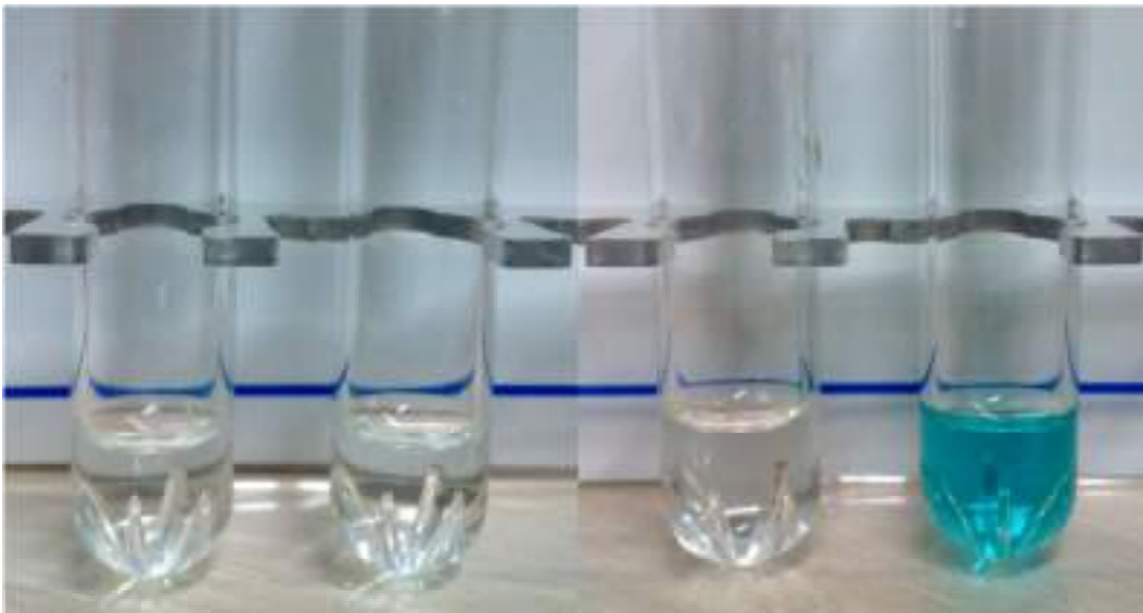
Abbildung 5: Teströhrchen vor und nach dem Farbumschlag: links: Teströhrchen nach der Zugabe von 12 Tropfen „Substrat“, rechts: Teströhrchen nach der Inkubationszeit (links: ohne Farbumschlag mit entsprechend hohem P4 der Ausgangsprobe, rechts: deutliche Blaufärbung, hervorgerufen durch niedrigen P4-Gehalt der Ausgangsprobe)
